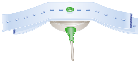
Schallkopf- und Gurtbefestigung
